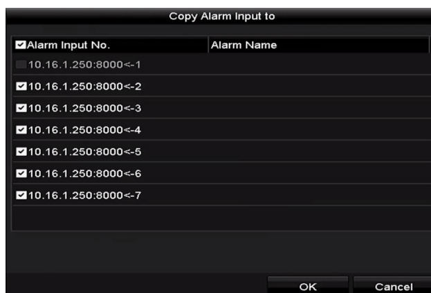
Obrázek 8–9 Kopírování nastavení vstupu alarmu
