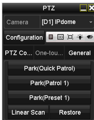
Obrázek 4–13 Panel PTZ – jednodotykové ovládání
