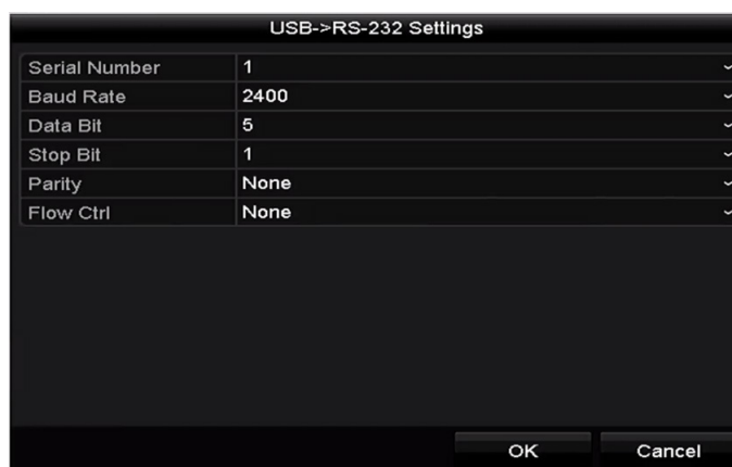
Obrázek 9–8 Nastavení převodníku USB-RS-232
